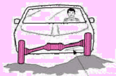
แกนล้อชนิดที่สามารถหมุนได้ และไม่ไถ่ลู่ ในแนวระนาบกับจุดยึด เพราะใช้ข้อต่อ (Universal Joint)
