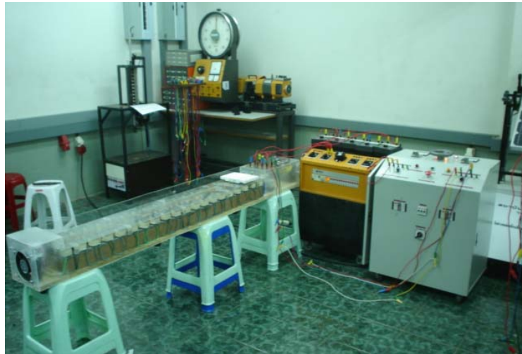
รูปที่ 13 การทดสอบชุดจำลองรถไฟฟ้าลอยเหนือรางขับเคลื่อนในแนวเส้นตรงด้วยสนามแม่เหล็ก
